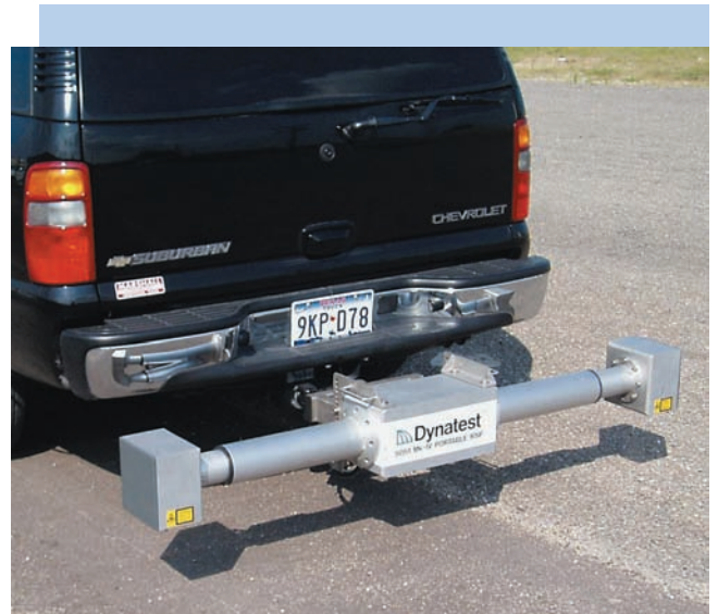
EL RSP MARK IV ESTÁ DISEÑADO PARA SER CONECTADO A DIFERENTES VEHÍCULOS Y PUEDE SER REMOVIDO FÁCILMENTE
